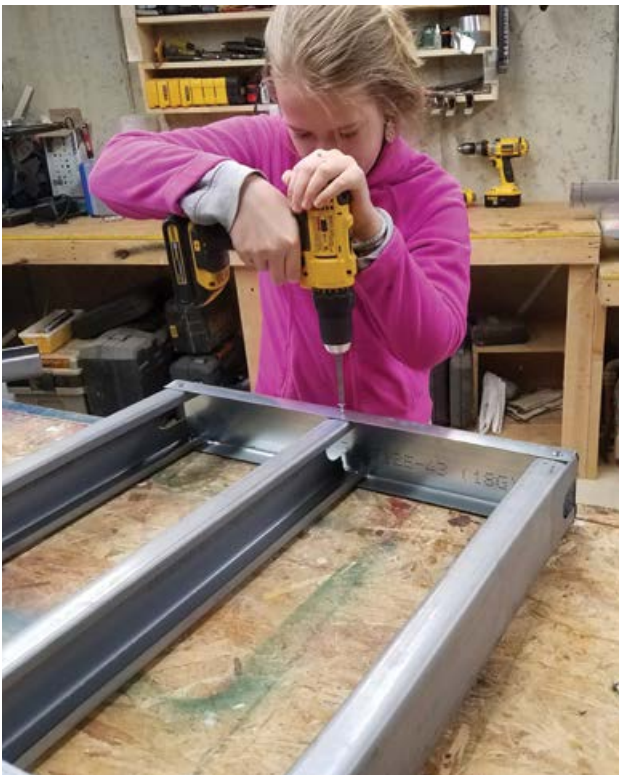
Steel stud construction for the mini "hot box".
